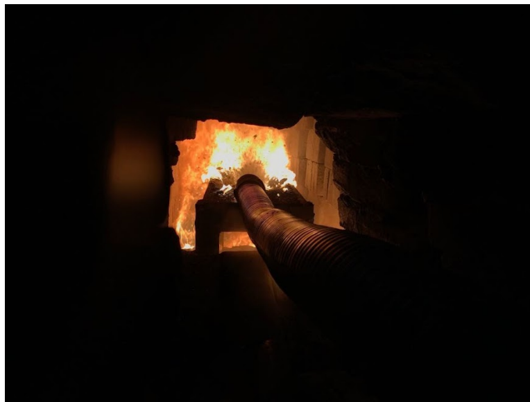
Figura 19: Parrilla refractaria posicionada a la entrada del horno
