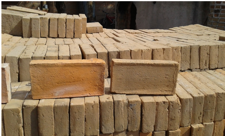
Figura 15: Variación en el tono del ladrillo en la misma quema
