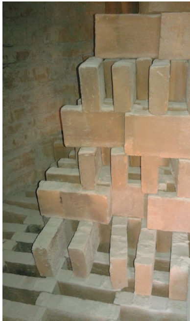
Figura 22: Ladrillos del horno norte (1) ahumados por la quema del horno sur (2) sistema MK2
