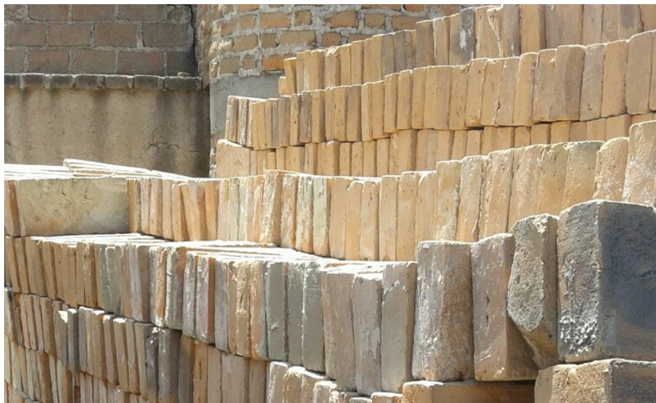
Figura 17: Ladrillos mal cocidos después de la prueba de secado forzado/fibra adicionada
